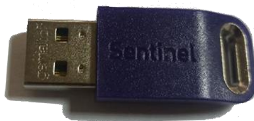
Рис. 5.2. Современная модель ключа Sentinel SuperPro/Sentinel HL
